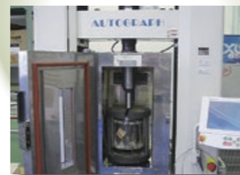
加熱状態での引張試験状況
