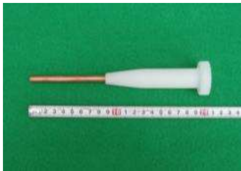
写真 2-14 コーンノズルに真鍮パイプを接続
