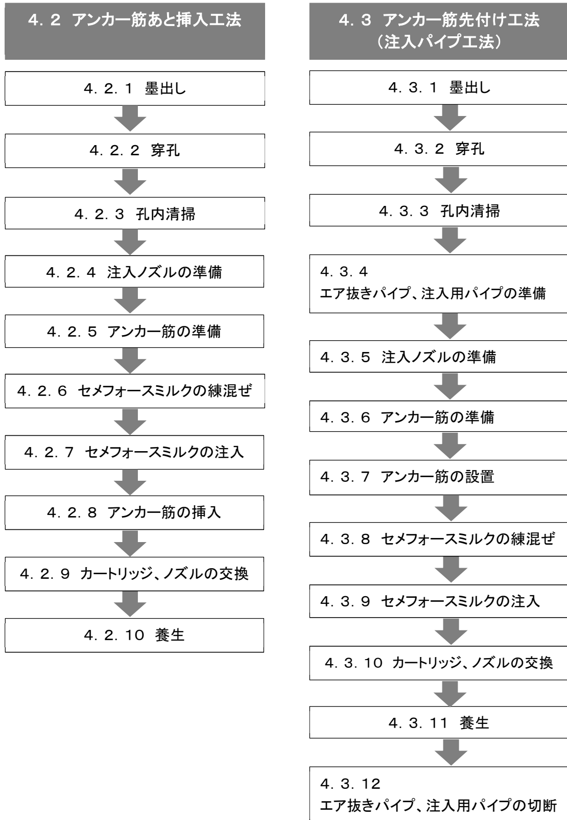
図 4-1 セメフォースミルクの施工フロー
