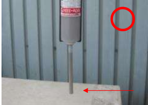
写真 4-15 混合良品のアンカー材料を 押し出したところ
