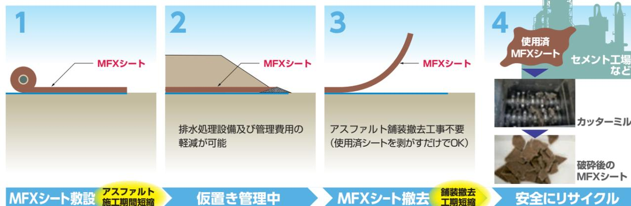
工場製品であるため、母材と吸着材を現場で混合する事を必要とする吸着層工法と比較し、品質のパラツキが少ない。当社では汚染土壌の分析、敷設効果の判定から使用後のシートを自社のセメント工場にて原燃料としてリサイクルを検討する処分まで、一貫した仮置き汚染土壌対策ソリューションを提供するための体制を検討しております。
