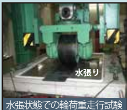
水張り 水張り状態での輪荷重走行試験
