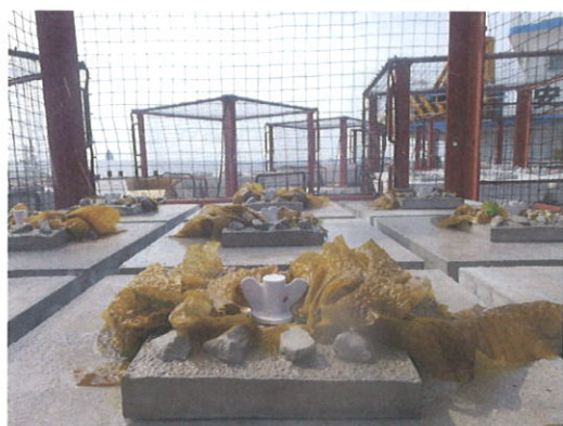
写真7 モルタル製プレート「藻場増殖プレートタイプ1HB」に設置された沈設直前の状況
