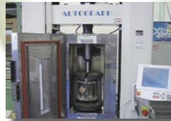
加熱状態での引張試験状況
