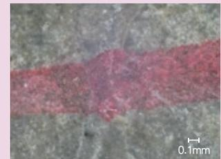
⑥ 水分供給後に、ひび割れが閉塞した状態
