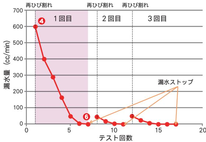
水分の継続的な供給で漏水量が減少、最終的に漏水がストップ。再度ひび割れさせても同様の効果が確認できた。
