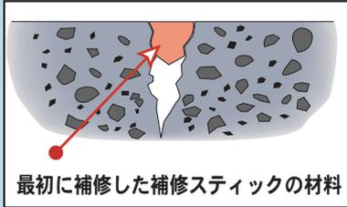
最初に補修した補修スティックの材料、ひび割れ周囲の色調と合わせ、素早くキレイに外観補修します。
