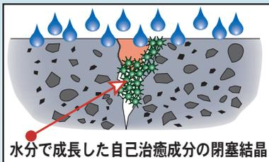
ひび割れが開いても、水分が供給されると自己治癒成分が成長・閉塞
