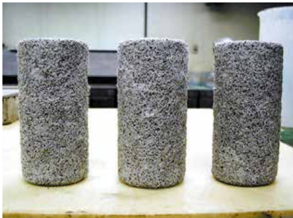
市販断面修復材の硫酸浸漬試験後
