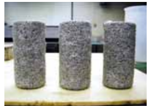
市販断面修復材の硫酸浸漬試験後
