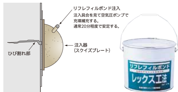
注入工法標準施工図
